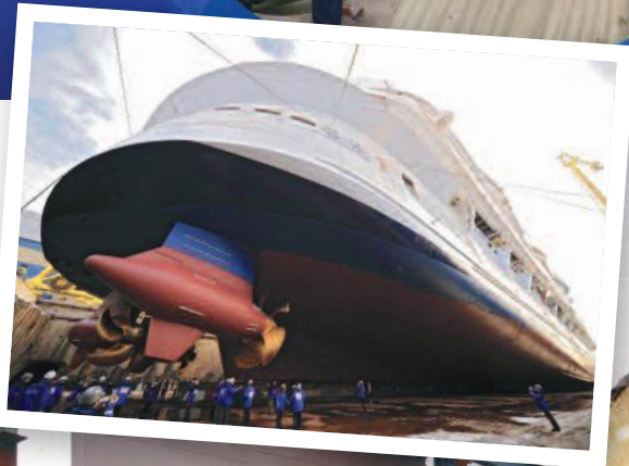
Martin Lavoie devant une hélice et un Azipod de l' Oasis of the Seas
